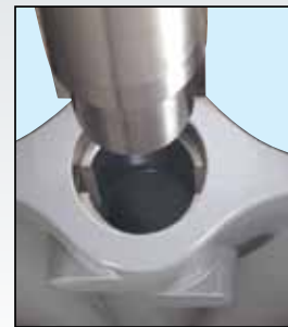
Liaison disque-arbre à double clavette
